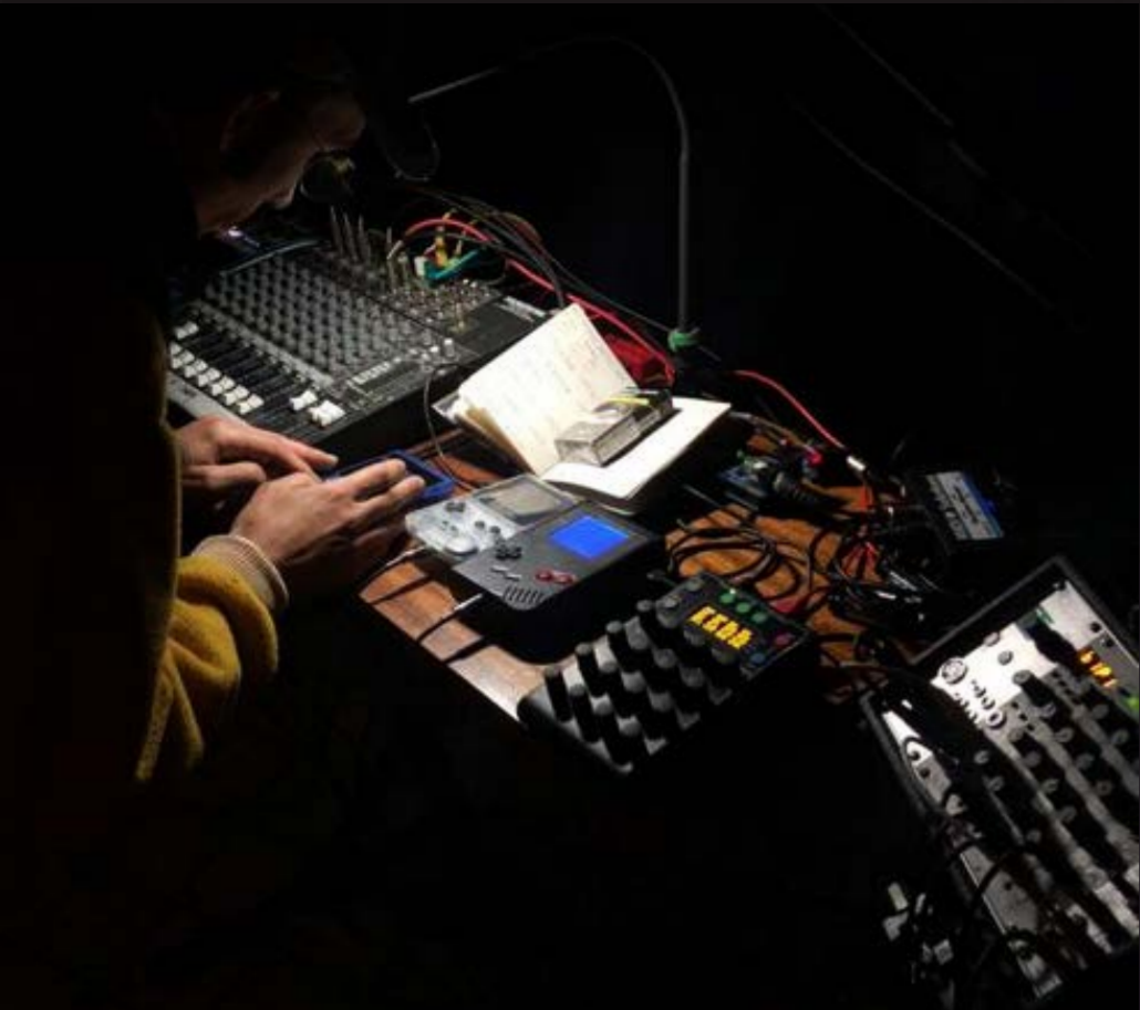
instrumentarium à Chantelouve 2022 de gauche à droite : table de mixage, GB Boy (shitwave et droneboy), gameboy color (nanoloop), gameboy DMG (LSDJ), contrôleur midi, synthétiseur modulaire
